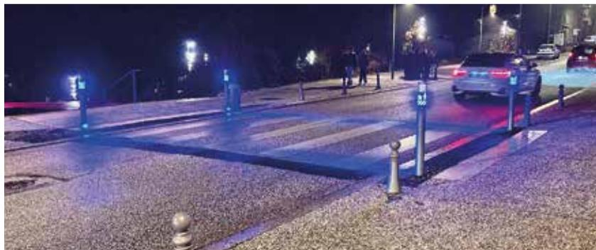
Un dispositif innovant a été installé sur le passage piéton reliant l'église et le supermarché Casino pour renforcer la sécurité des usagers. Deux potelets lumineux, placés de chaque côté du passage, s'éclairent en couleur dès qu'un piéton s'engage, signalant ainsi sa présence aux automobilistes.
