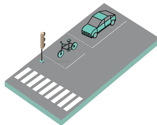
Le sas vélo est un espace sur la chaussée visant à faciliter la traversée d'un carrefour par les cyclistes, lorsque les voies sont équipées de feux de signalisation. Ce sas permet aux cyclistes d'être mieux vus, de mieux se positionner pour tourner à gauche, de démarrer avant les véhicules et aussi de ne pas être placés derrière les gaz d'échappement des voitures.
